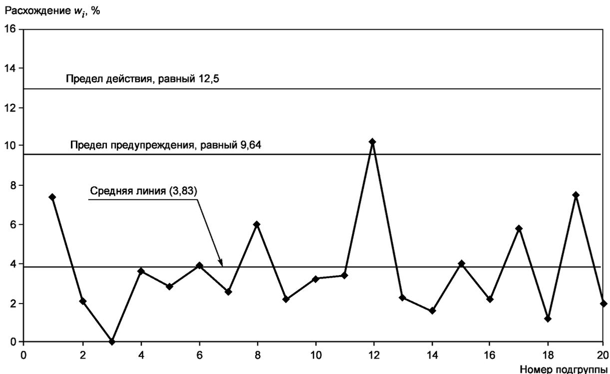
Рисунок В.2 — Карта пределов определения массовой концентрации 2-пропанола, мг/дм<sup>3</sup>, в спирте, полученных в условиях промежуточной прецизионности с изменяющимися факторами «время» и «оператор»
