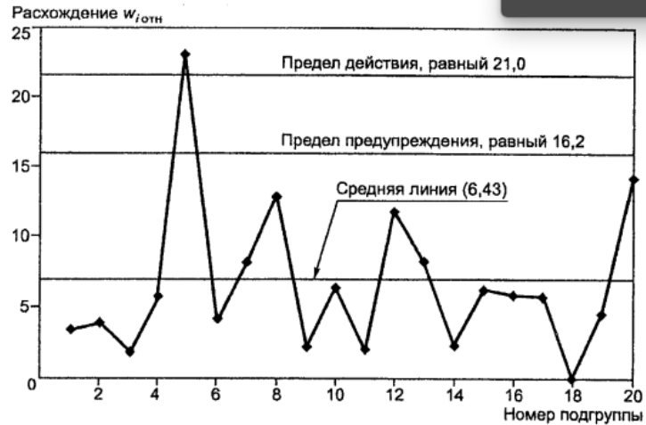
Рисунок 0.1 — Карта пределов определения объемной доли метилового спирта (%) в водке, получениях в условиях промежуточной прецизионности с изменяющимися факторами «время» и «оператор»
