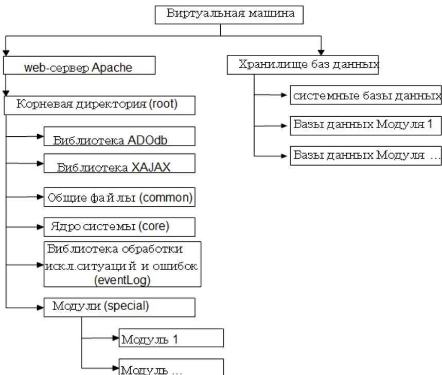
Рис. 1.3. Организационная структурная схема фреймворка eLab
