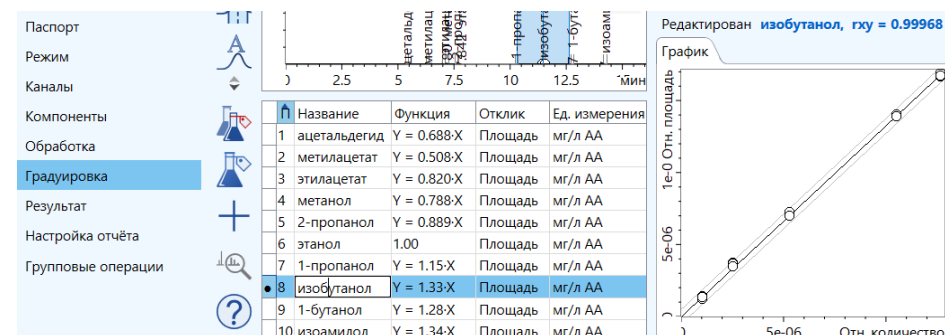
Результат контроля линейности – 5 уровней с применением СО PB-2, PB-3, PC-1, PC-2, PC-3
